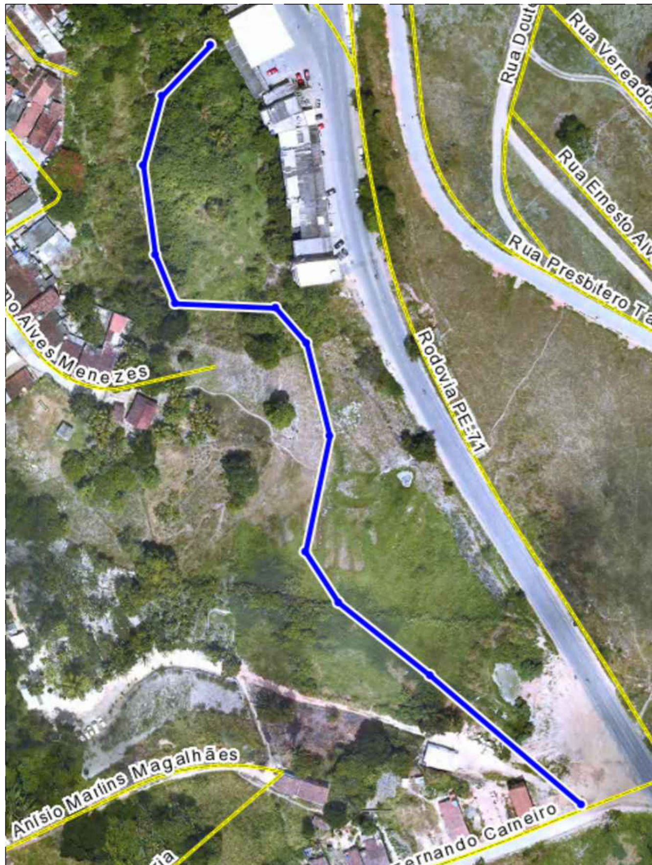
CANAL DA RUA EDSON FERNANDO CARNEIRO TUBOS: Ø 1000mm COMPRIMENTO: 365,00m
