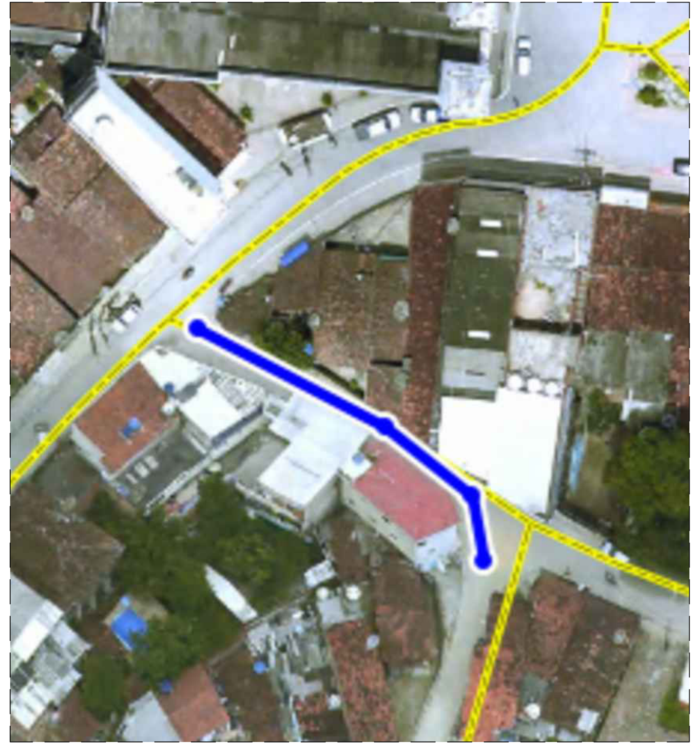
CANAL DA RUA JOÃO BATISTA DE VASCONCELOS TUBOS: Ø 400mm COMPRIMENTO: 40,00m
